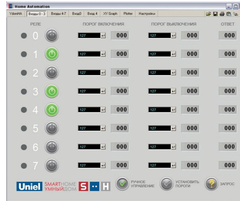
Программное обеспечение Home automation для модуля управления автоматикой имеет дополнительные опции, позволяющие строить вольт-амперные характеристики, графики зависимости сигнала (входного и выходного) от времени, производить расчеты и т.д.
